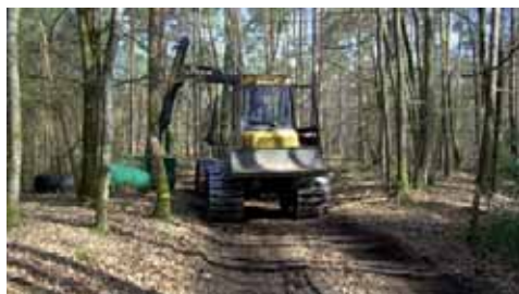
Tracks montés sur un porteur forestier
