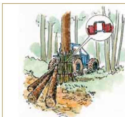
Le manchon de protection permet aux grumes débardées de toucher un arbre sur pied sans laisser de traces, c'est-à-dire sans le blesser
