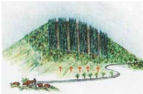
Le décalage des couloirs de deux lignes, avant d'atteindre la crête, supprime l'effet de créneau
