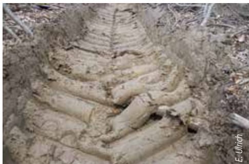
Compactage après 40 passages avec un porteur
